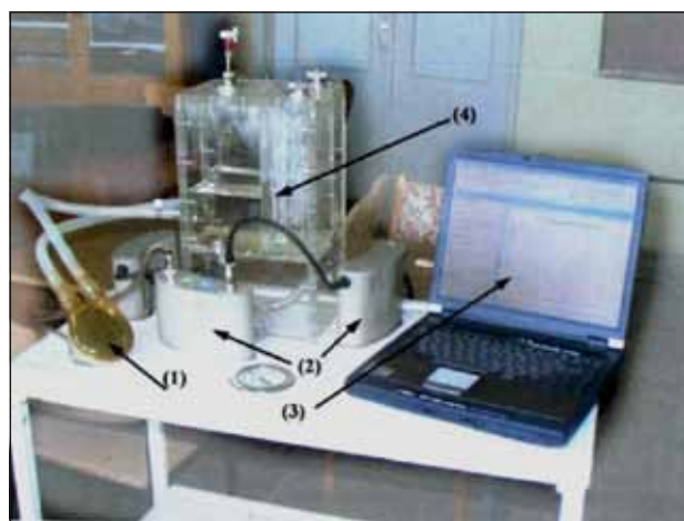
Рис. 3. Опытный образец электромеханической имплантируемой системы ОЛЖ, разработанный в МАИ и НИИ ТиИО, во время её испытаний на гидродинамическом стенде
